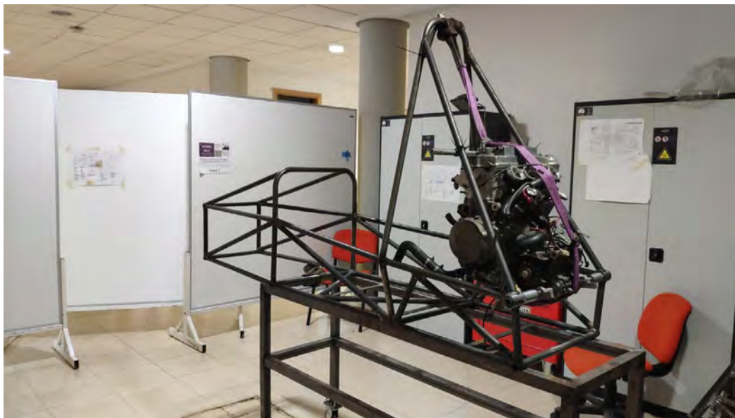
Figura 5. Chasis tubular del monoplaza de competición
