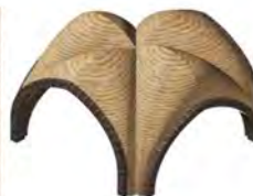
Diseño de una bóveda de crucería en "nido de golondrina"
